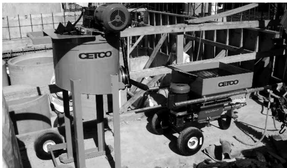
Rysunek 2: Pompa i mieszadło firmy CETCO z silnikiem elektrycznym o mocy 1 KM
